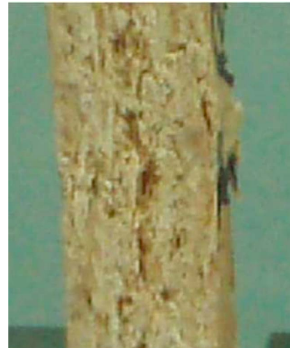
Figure 4 : Mécanismes de dégradation (délamination longitudinale)
