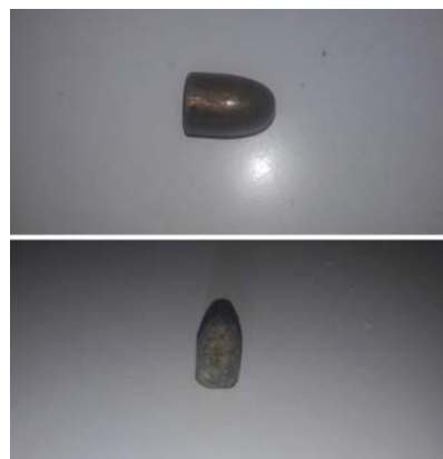
b) Balles retirées intactes du béton mousse de densités 1,2 et 1,4
