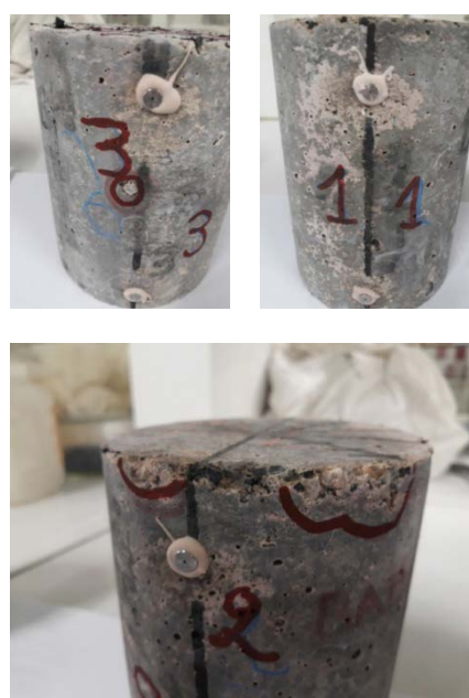
Figure 5 : Echantillons des BAP15C après 160 jours d'immersions dans une solution sulfatique de dosage 10 g/l
