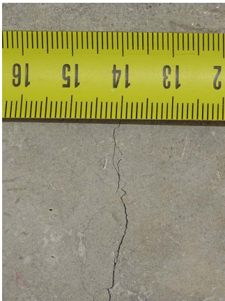
Figure 8 : Fissure dans l'échantillon avec de la paille après rupture
