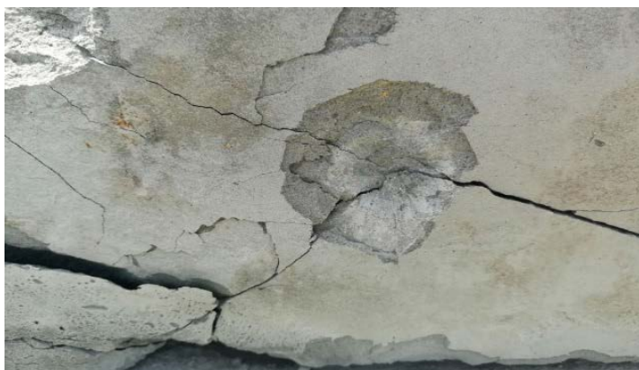
a) Impact d'une balle de type A sur un mur en mortier de densité 2,1 (la balle a ricoché)
