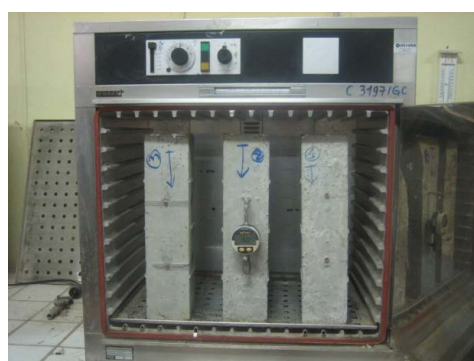
Figure 1 : Eprouvettes dans l'étuve à vapeur
