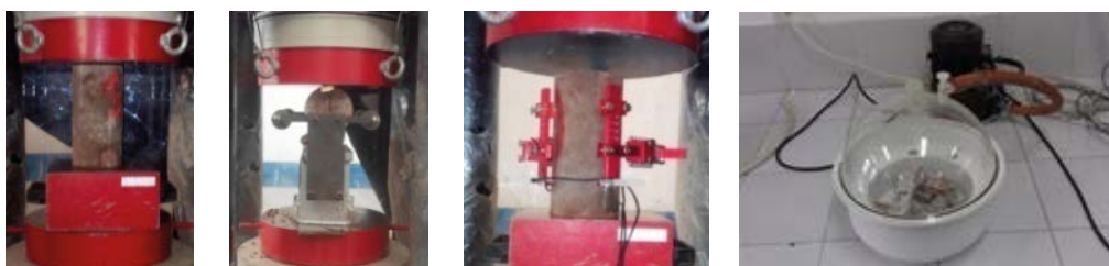
Figure 4 : Essais réalisés sur béton durci : a) Essai de compression ; b) Essai de traction par fendage ; c) Essai du module d'élasticité ; d) Essai de la porosité ouverte
