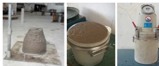
Figure 3 : Essais sur béton frais : a) Mesure d'affaissement au cône d'Abrams ; b) Essai de l'air occlus
