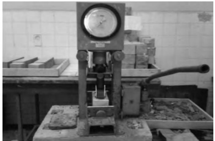
Figure 6 : Dispositif de flexion
