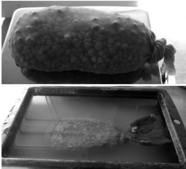
Figure 8. Essai d'absorption d'eau des granulats.
