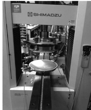
Figure 17. Essai de compression uniaxiale.
