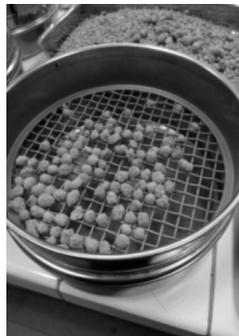
Figure 4. Essai de tamisage.
