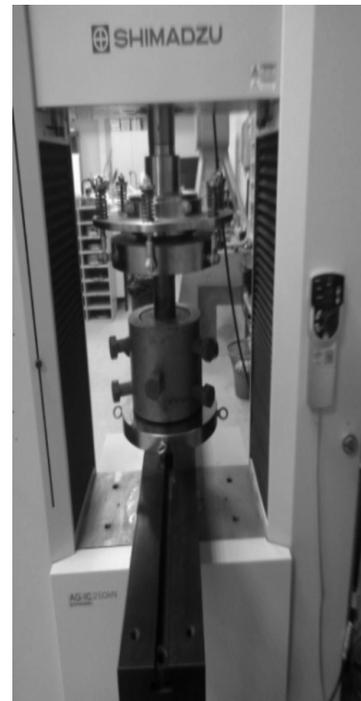
Figure 10. Essai d'écrasement en vrac des granulats.
