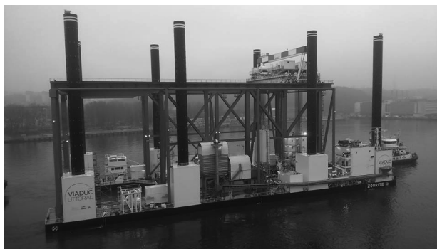
Figure 1c : Méga-barge « Zourite » utilisée pour l'installation des piles de pont (Crédits photos : Viaduc Littoral / Sébastien Marchal)
