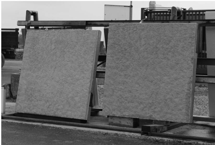
**Produit préfabriqué à base de granulats recyclés - CMEG**
