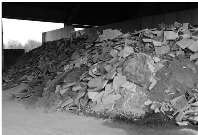
**Rebuts de fabrication destinés à être broyés puis recyclés - MARLUX**
