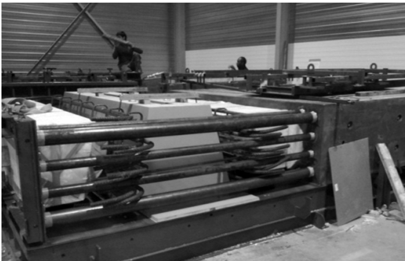
Photo 10 : Voussoir fenêtre avec armatures de renfort et noyaux spécifiques © Eiffage TP.
