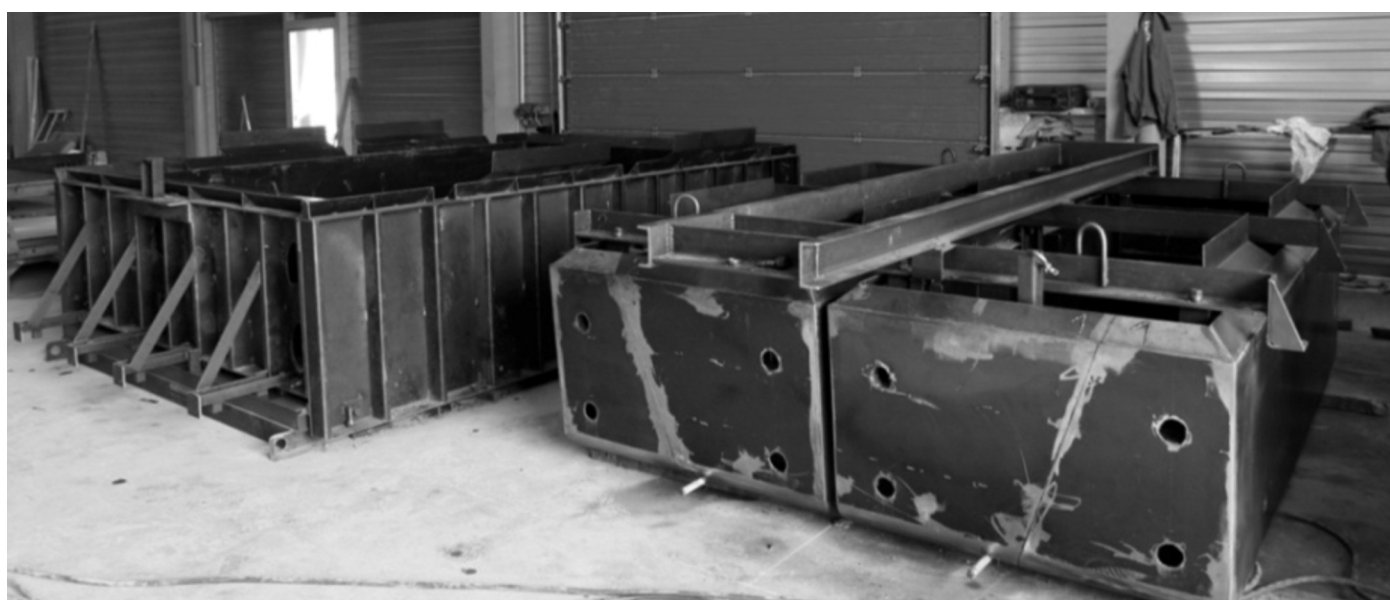
Photo 5 : Moule et noyaux des voussoirs simples © H. Abbadie.
