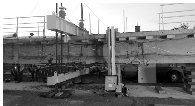
Seconde rupture des renforts composites collés notamment renforts centraux de la seconde phase de renforcement.
