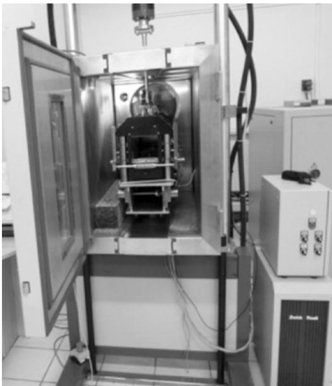
Figure 5. Banc de fatigue en flexion en quatre points et montage de l'éprouvette
