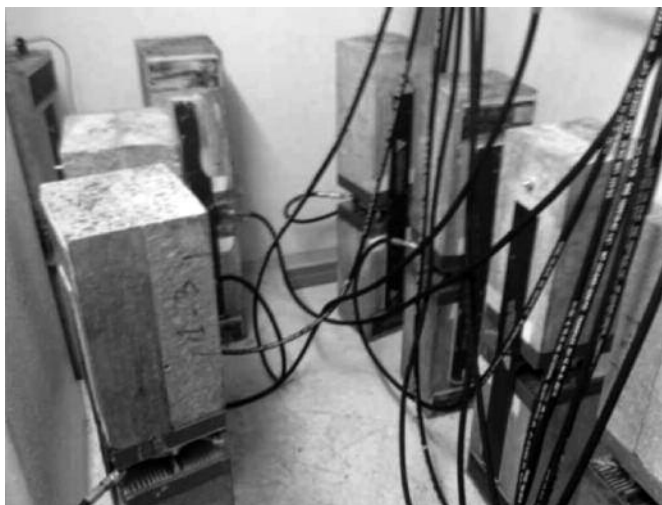
Figure 20. Banc de fluage en fonctionnement dans la salle de vieillissement du DLA.
