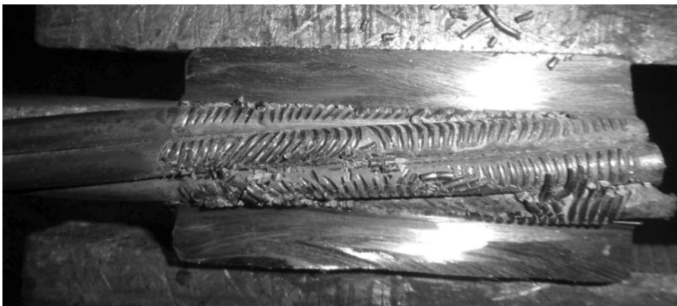
Photo 3 : Coupe d'un manchon, empreintes du ressort sur 3 fils, et, à droite, éléments du ressort.
