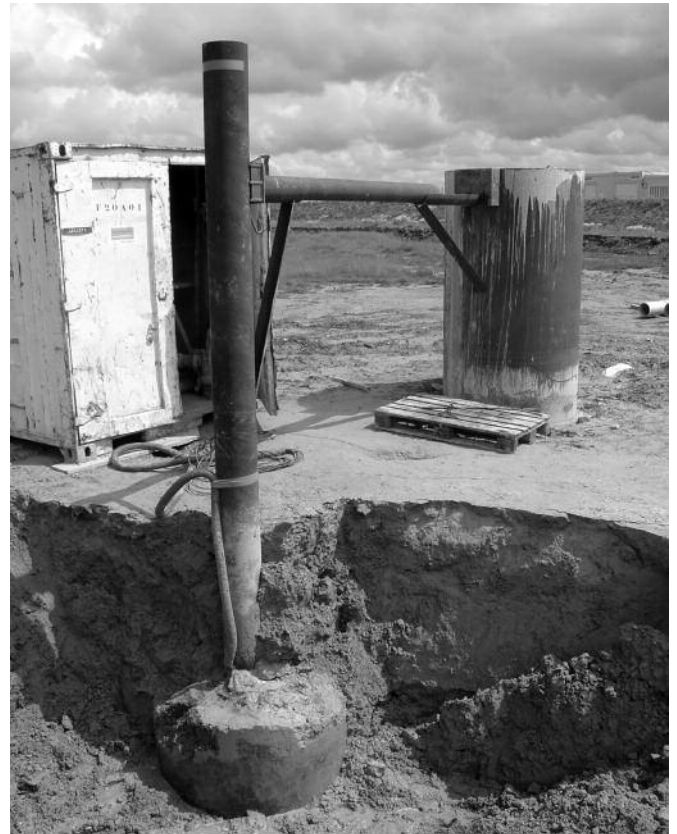
Fig. 10. Excavation après l'essai pour constater visuellement l'état du pieu (juin 2012).
