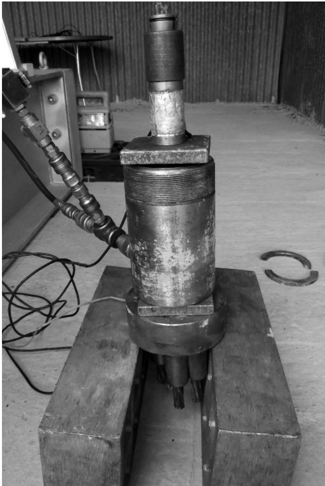
Photo 7 : Étalonnage effort/ déformation sur manchon.
