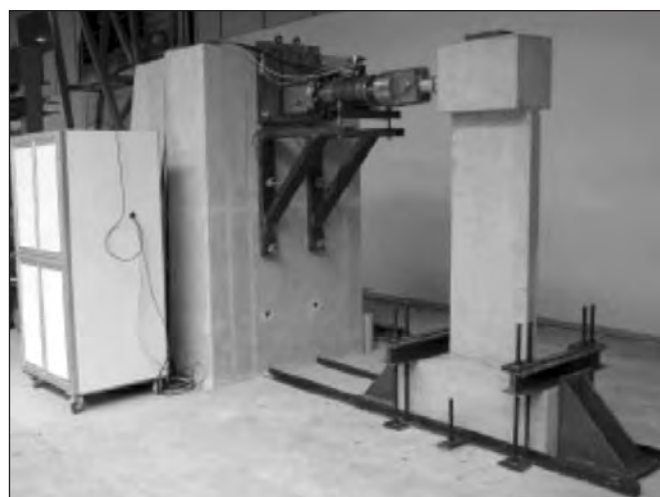
Figure 7 : Mur de réaction du LGCIE-Université de LYON pour tester les voiles.
