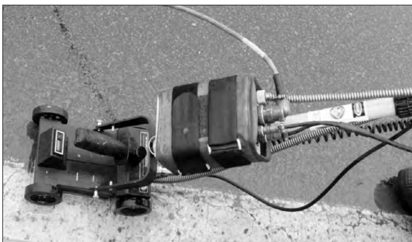
Figure 5 : Auscultation radar de la dalle et de son étanchéité
