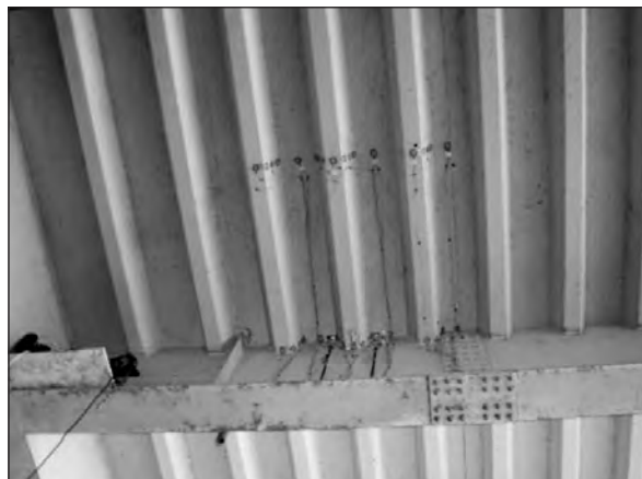
Photo 10 :Instrumentation du platelage – source : CETE de l'Est
