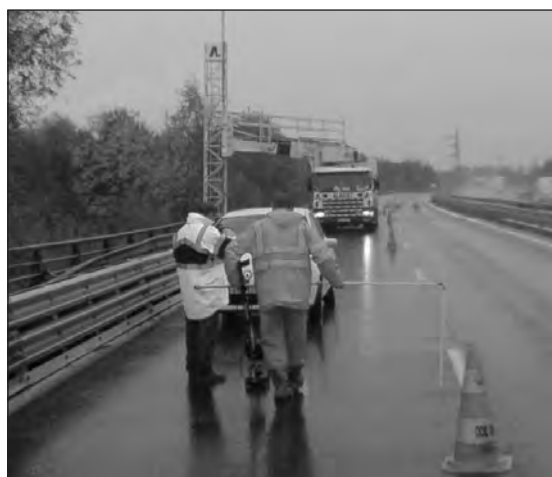
Figure 5 : Auscultation radar de la dalle et de son étanchéité
