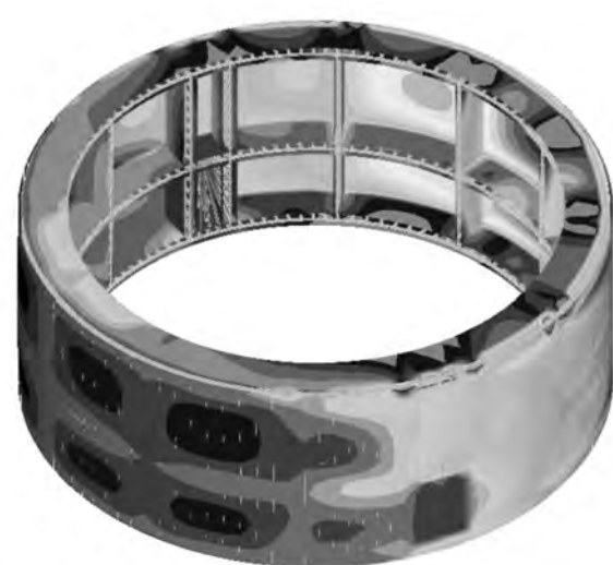
Figure 11 : Contrainte normale longitudinale (combinaison ELU -configuration 2)
