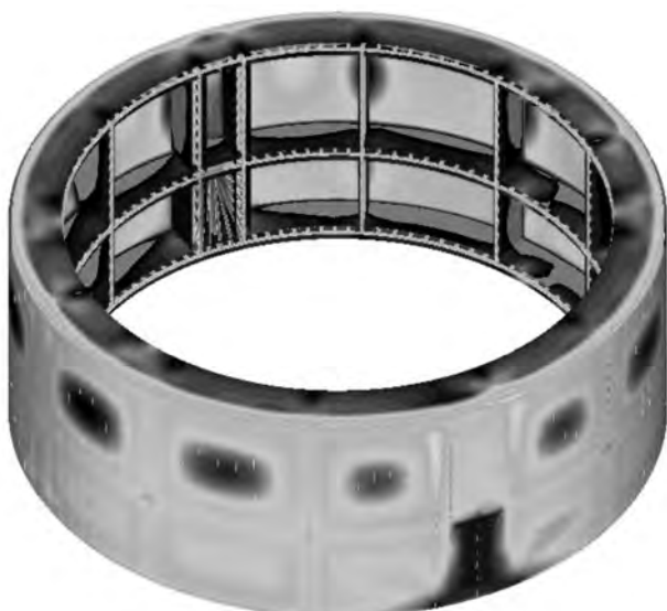
Figure 8 : Contrainte normale circonférentielle (phase provisoire)
