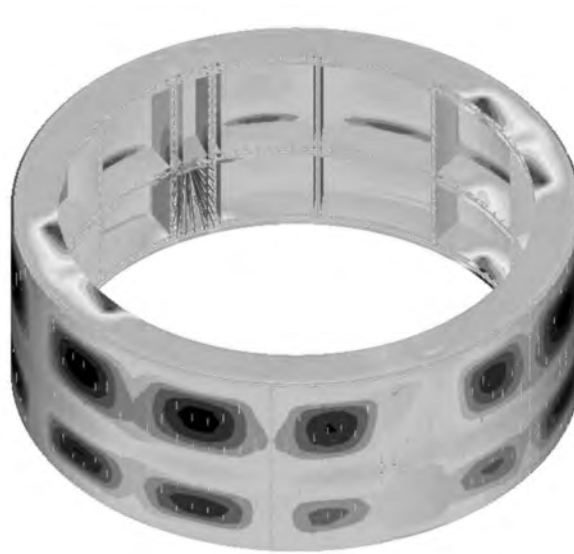
Figure 9 : Contrainte normale longitudinale (phase provisoire)
