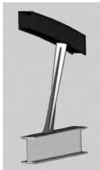
Figure 11 : Schéma d'une suspente
