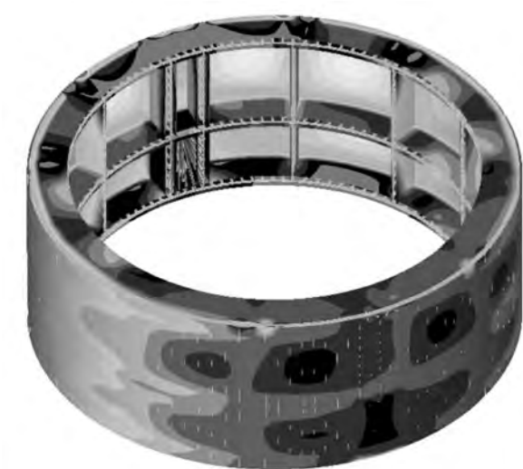
Figure 10 : Contrainte normale longitudinale (combinaison ELS -configuration 1)
