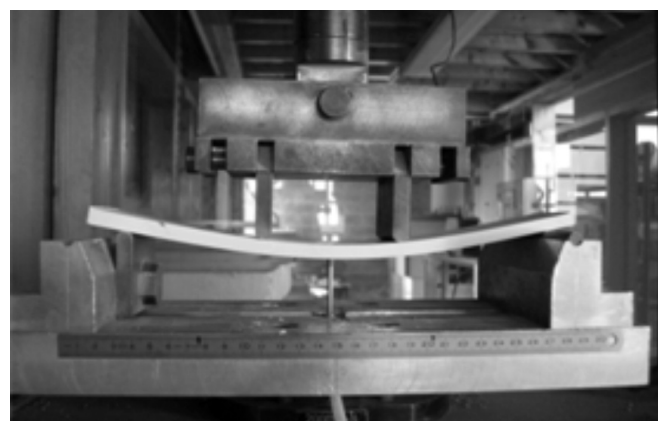
Figure 4. Dispositif expérimental de l'essai de flexion 4 points
