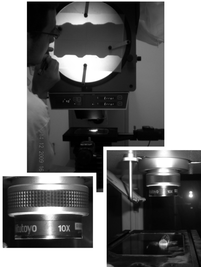
Fig.9 : Prise des mesures à l'aide du photoprojecteur
