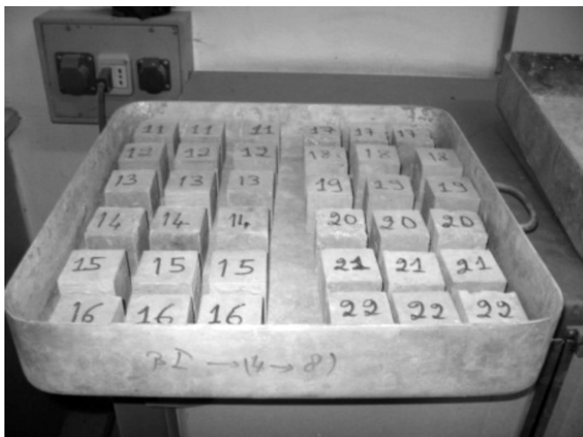
Figure 3. Cubes de béton à granulats recyclés pour l'essai de porosité
