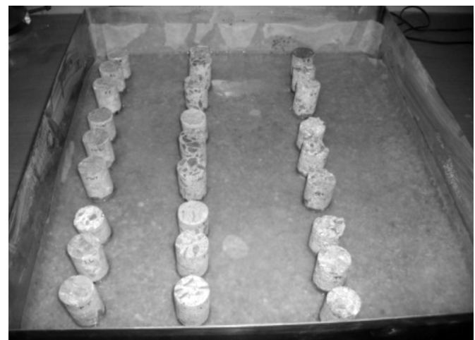
Figure 4. Dispositif d'essai d'absorption capillaire.
