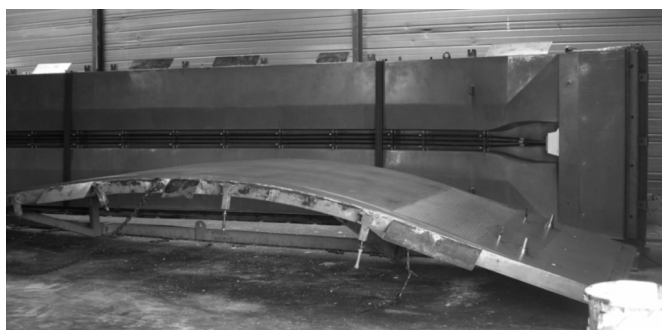
Figure 16 : Coffrage métallique des coques courbes
