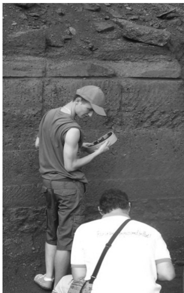
Figure 3. Test au scléromètre - marteau de Schmidt
