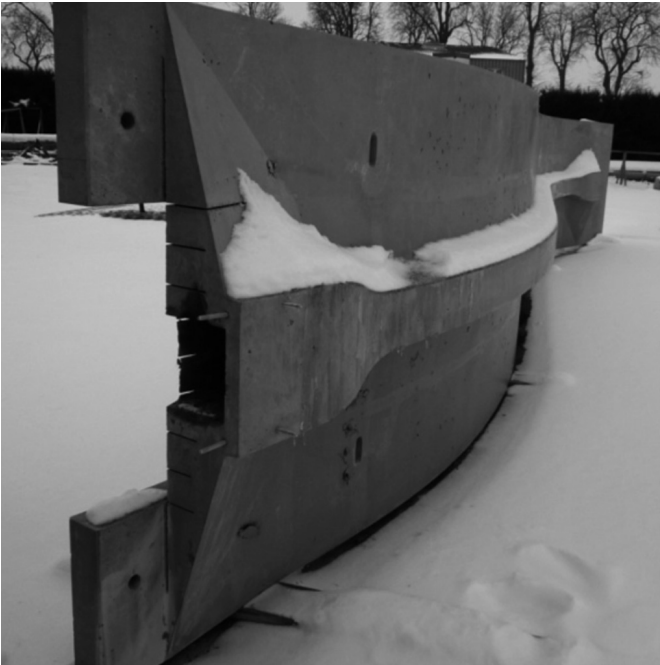
Figure 12 : Prototype après prélèvement des prismes
