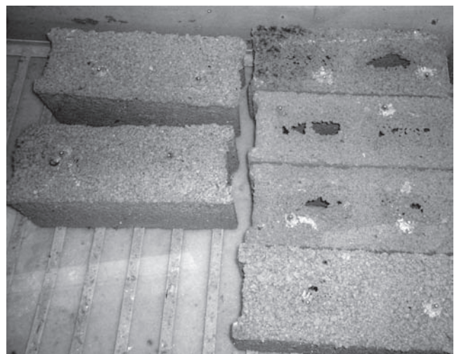
Figure 11. Mesure du gonflement par immersion (blocs dans le bac à eaux).
