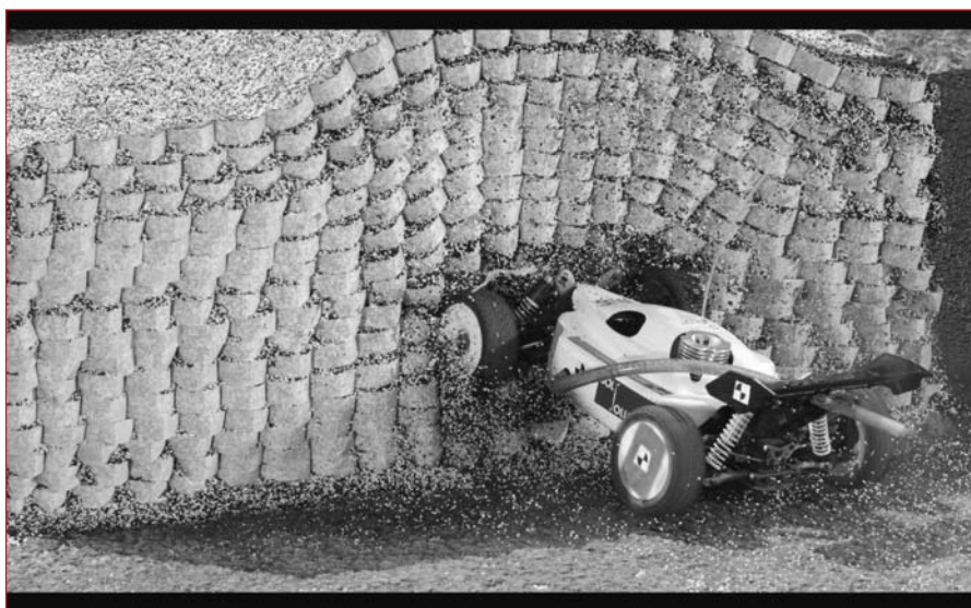
Figure 5. Expérience d'impact d'un véhicule sur un ouvrage en sol renforcé à échelle 1/10 e
