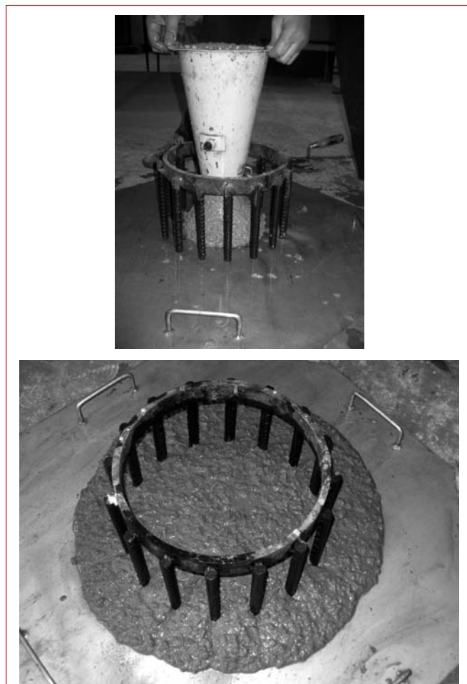
Figure 2. Mesure de l'étalement à l'anneau japonais
