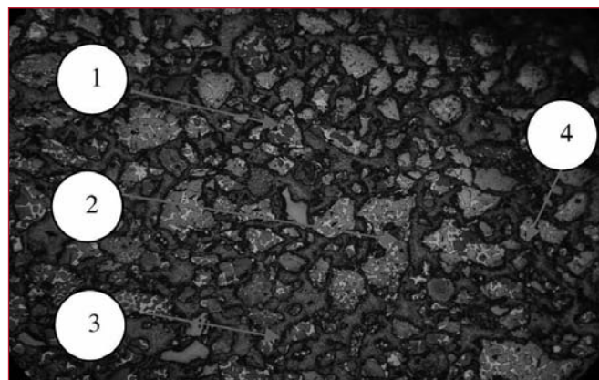
Figure 2. Les constituants minéralogiques de clinker : 1-CaO, 2-C 3 S, 3-phase liquide, 4-C 2 S.
