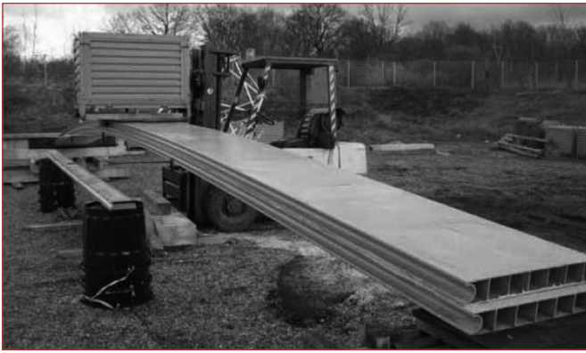
Figure 12 : Chargement de la poutre afin de mettre en place le câble central.
