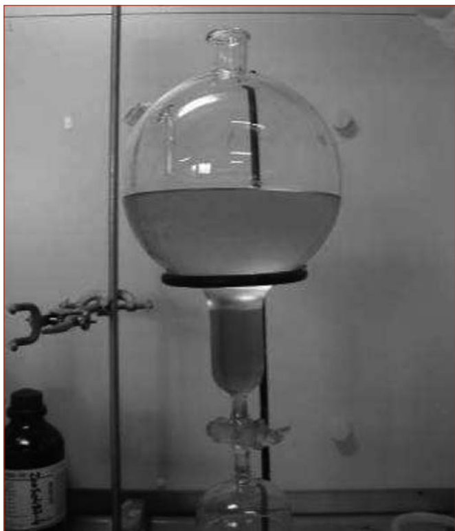
Photo 1 : Exemple de synthèse d'ester éthylique de soja.
