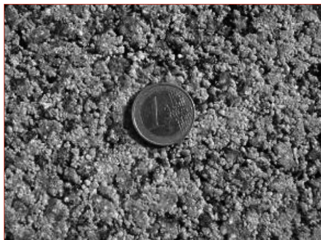
Photo 7 : Enrobé au liant végétal de couleur naturelle des granulats.
