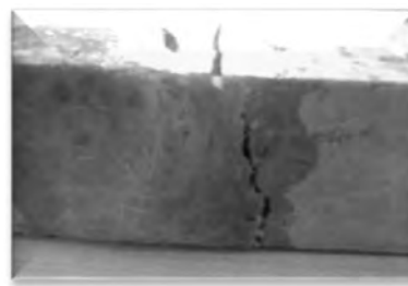
Figure 9 : Exemple de mode de rupture en flexion
