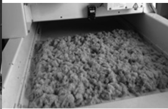
Figure 4 : Dépôt de la matière première sur le tapis alimentaire
