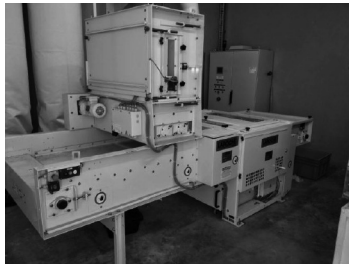
Figure 3 : Vue d'ensemble de l'ouvreuse nappeuse Laroche d'I2M, Talence
