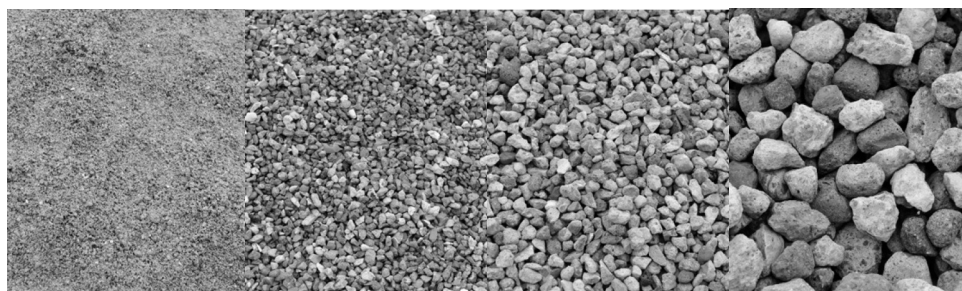
Granulats de béton recyclé – Coupures granulaires 0/4, 4/10, 10/20 et 20/40 mm - GRANUDEM
