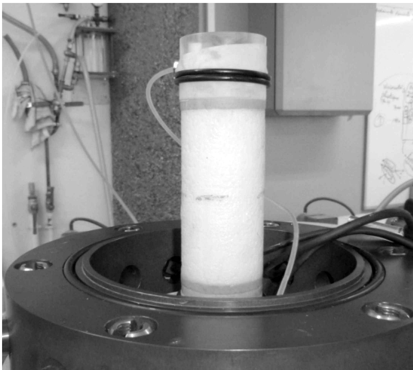
Figure 2 : Échantillon triaxial de sable de Fontainebleau reconstitué par la méthode de la sous-compaction humide.
