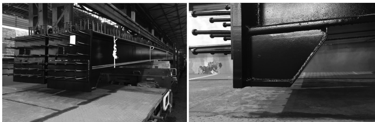
Figure 6 : La charpente métallique après application de la protection anti-corrosion.
