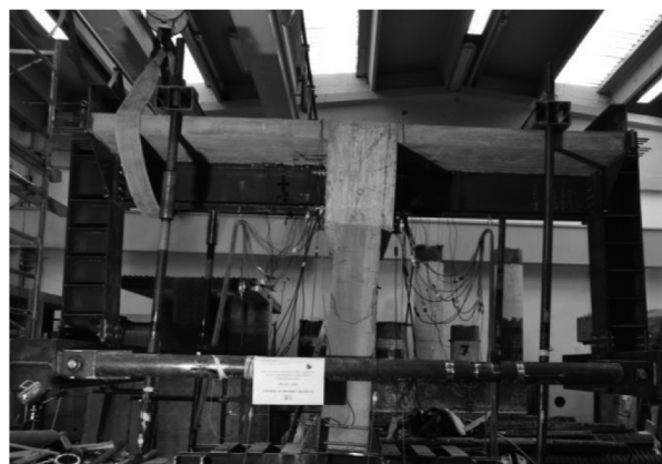
Figure 10 : Principe du fonctionnement des chevêtre en b.a. (gauche) et essai expérimental (droite).
