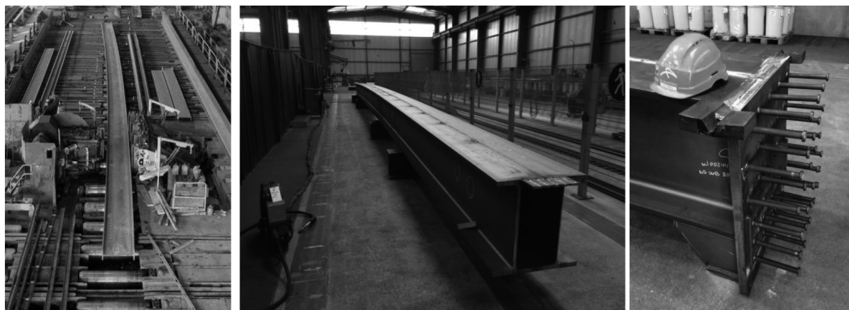
Figure 5 : Parachèvement de la charpente métallique : cintrage, assemblage des caissons, habillage.
