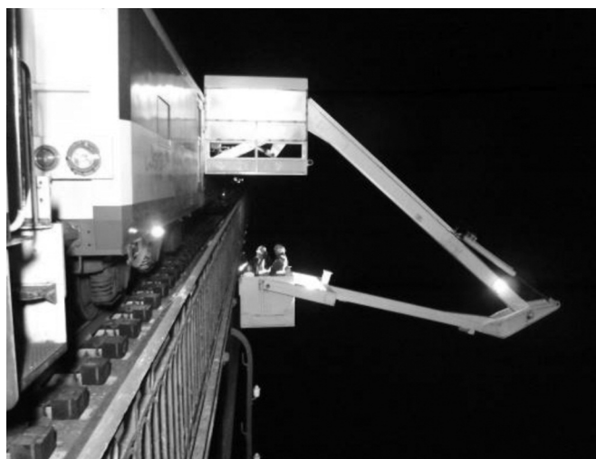
Figure 7 : Utilisation d'une nacelle négative sur wagon.
