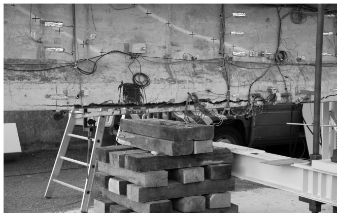
Première rupture des renforts composites collés latéraux de la première phase de renforcement.
