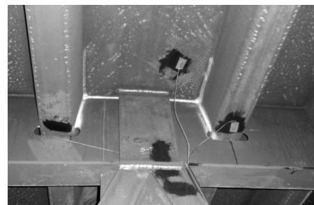
Figure 3 : Localisation des jauges de température sur coupe transversale.
