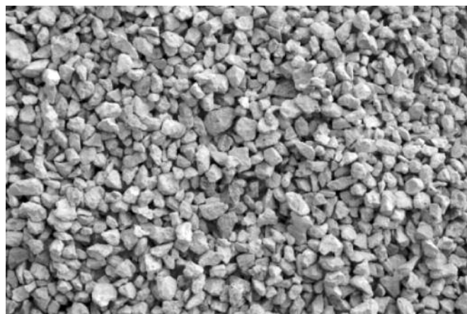
Figure 1 : Illustration de l'aspect du gravillon de béton recyclé 6/20
