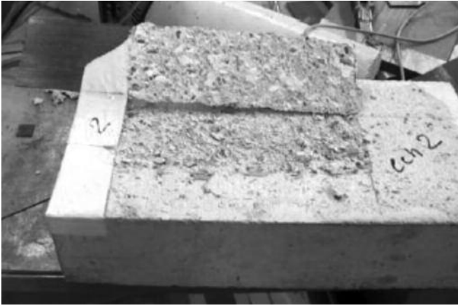
Figure 12. Photo d'un échantillon après rupture.
