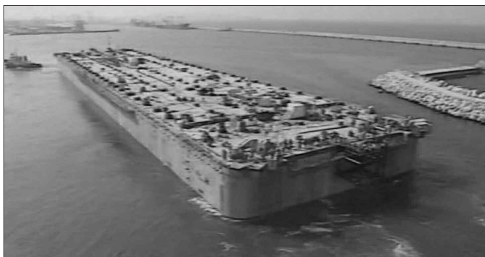
Figure 4 : Transfert de Marseille à FOS pour l'installation des Topsides
