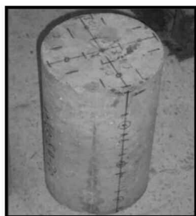
Figure 4 : Positionnement des points des mesures ultrasonores
