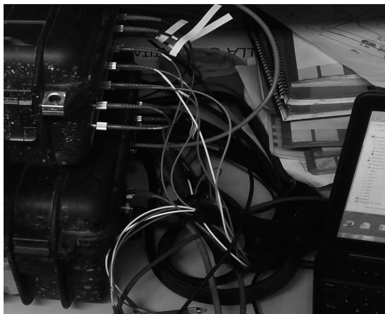
Figure 11 : Cabine de pilotage du tunnelier - Système d'acquisition et câblage optique.
