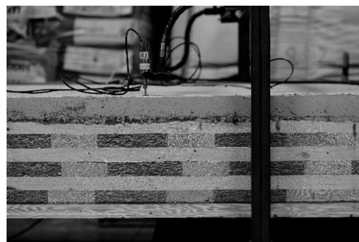
Figure 9. Dalle CLT creuse et béton formant un panneau multicouches à 8 plis à porosité organisée
