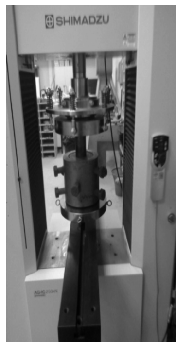
Figure 10. Essai d'écrasement en vrac des granulats.
