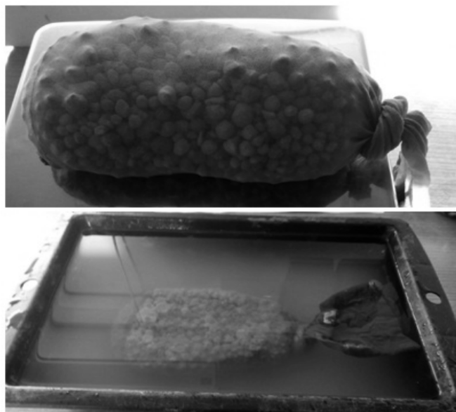
Figure 8. Essai d'absorption d'eau des granulats.
