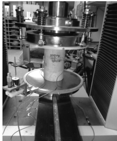
Figure 17. Essai de compression uniaxiale.
