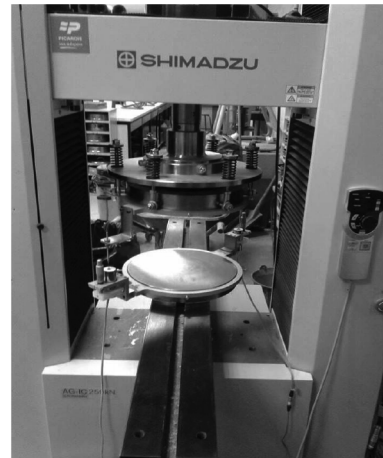
Figure 17. Essai de compression uniaxiale.
