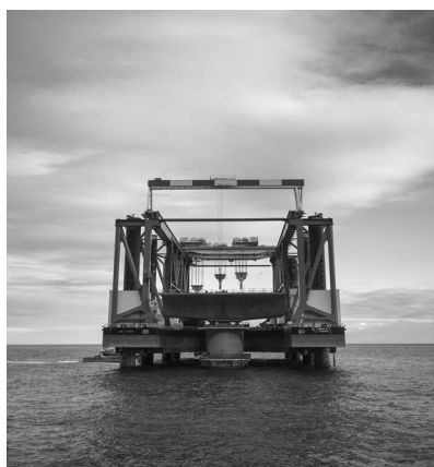
Figure 1c : Méga-barge « Zourite » utilisée pour l'installation des piles de pont (Crédits photos : Viaduc Littoral / Sébastien Marchal)
