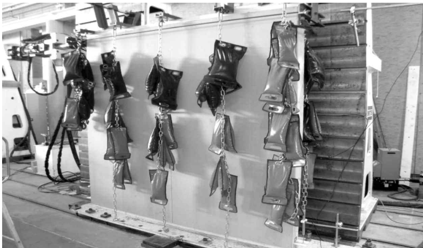
Figure 2. Montage pour les essais cycliques.
