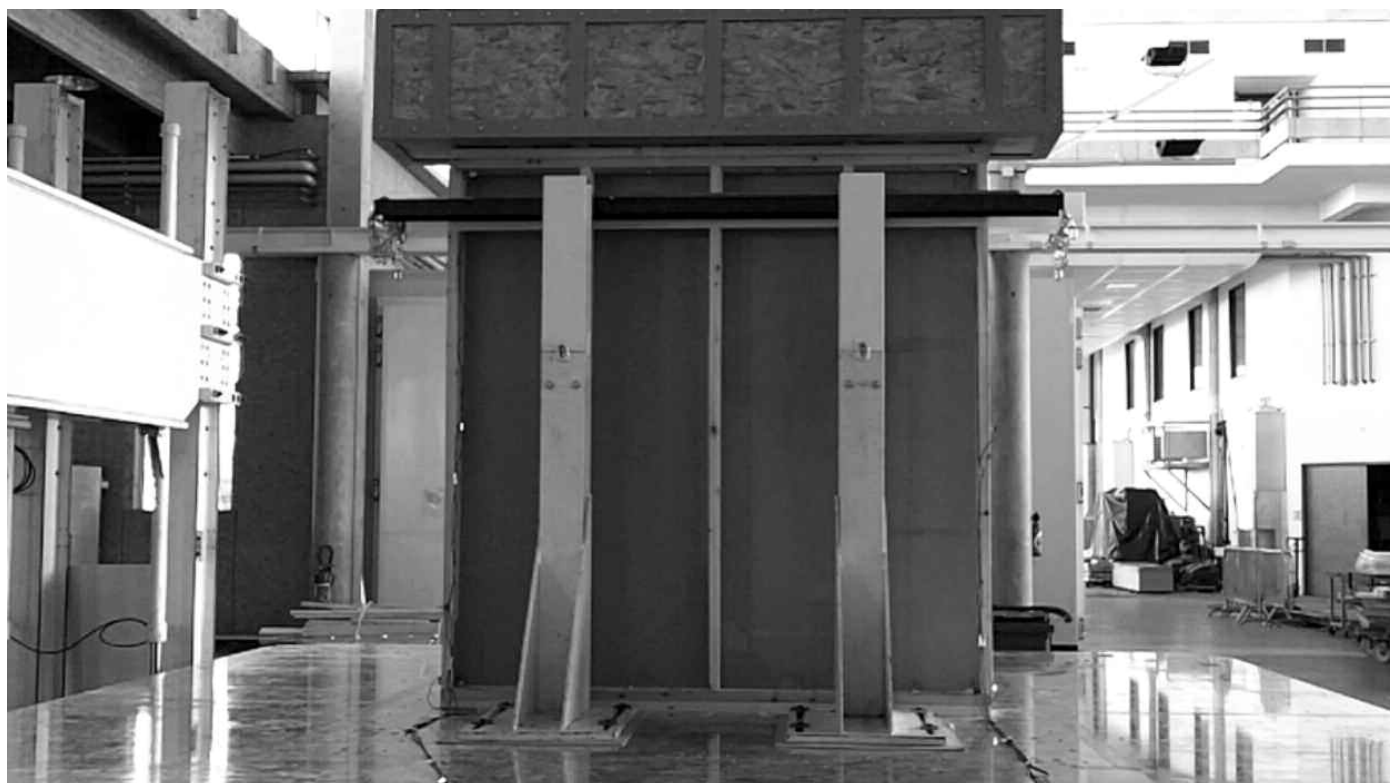
Figure 3. Mur à ossature bois placé sur la table vibrante de l'institut technologique FCBA.
