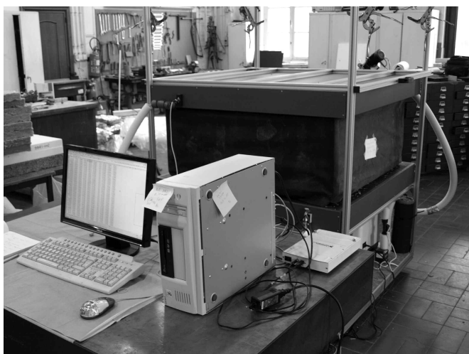
Figure 6. Plaque chaude gardée à une éprouvette.
