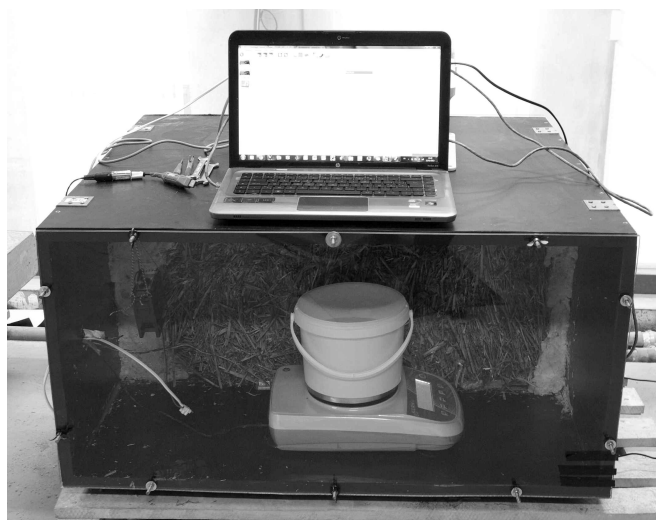
Figure 5. Essais de perméabilité à la vapeur sur un ballot de paille.
