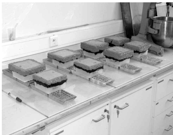
Figure 4. Essais de perméabilité à la vapeur sur enduits.
