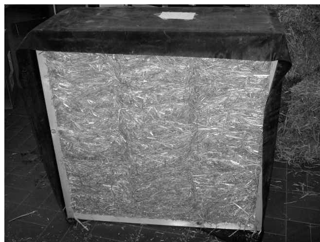
Figure 7. Cadre de paille testé sur la plaque chaude (1m x 1m).
