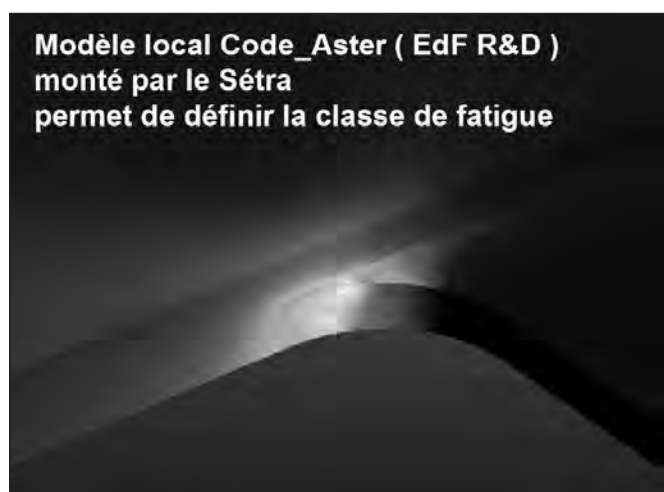
Figure 12 : Détermination par Code_Aster des zones à risques et traitement T.I.G.
