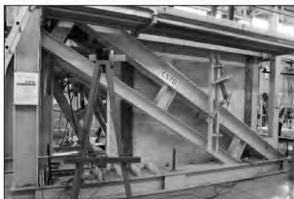
Figure 9 : Dispositifs d'essais du CSTB pour solliciter les maçonneries.
