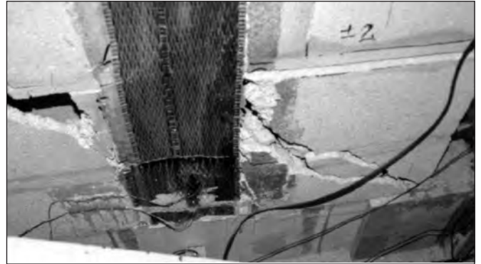
Figure 21 : Mécanismes de ruine mettant en cause la résistance au cisaillement des blocs en béton alvéolés.
