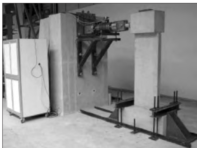
Figure 7 : Mur de réaction du LGCI-Université de LYON pour tester les voiles.
