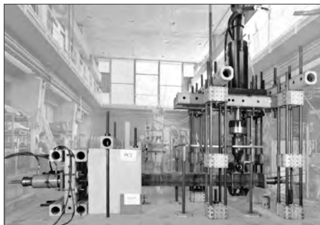
Figure 8 : Montages expérimentaux du LCPC (IFSTTAR) pour tester les poteaux BA.
