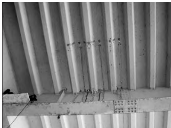
Photo 10 :Instrumentation du platelage – source : CETE de l'Est
