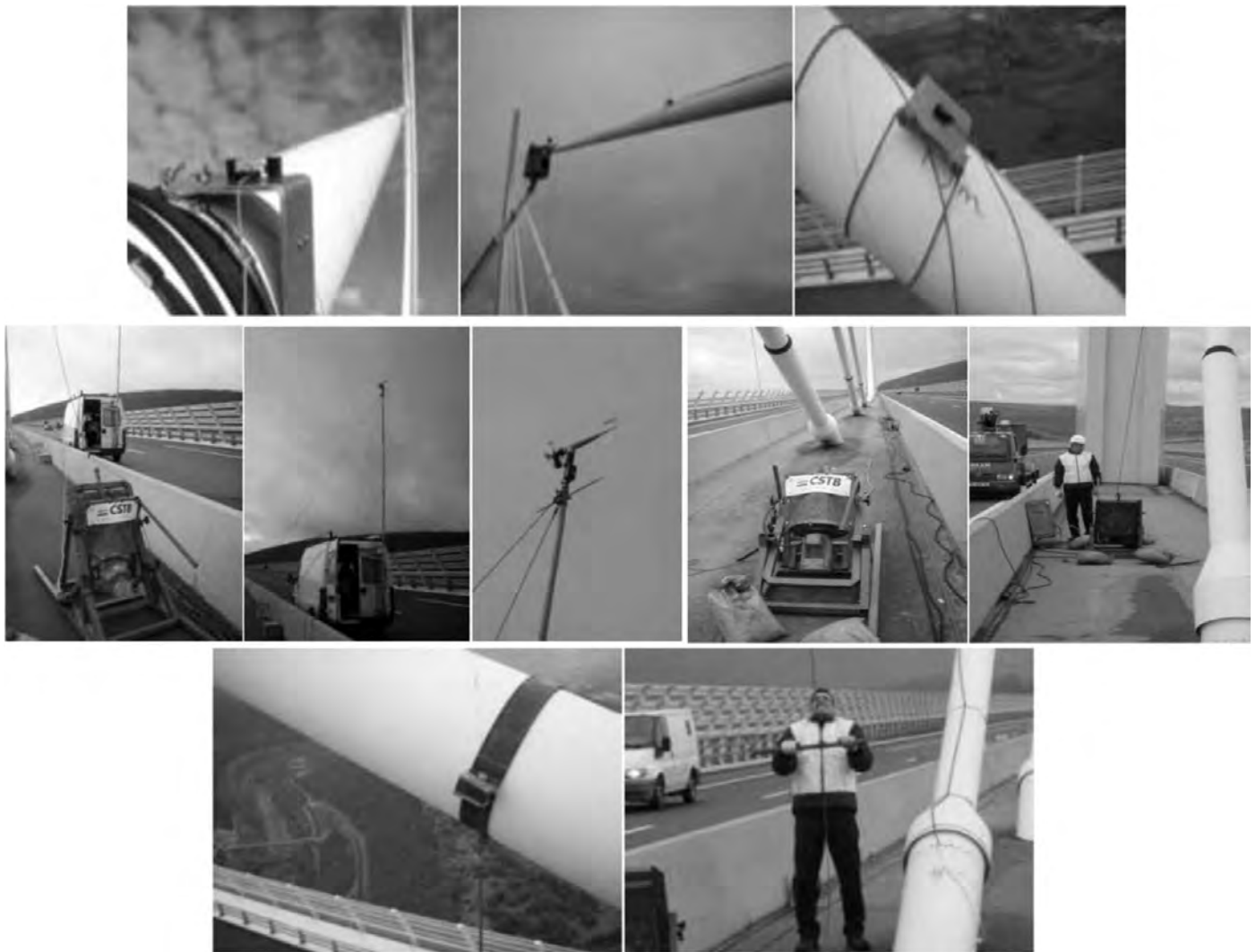
Photo 4 : Dispositif de mesure de l'amortissement des haubans (© CSTB)
