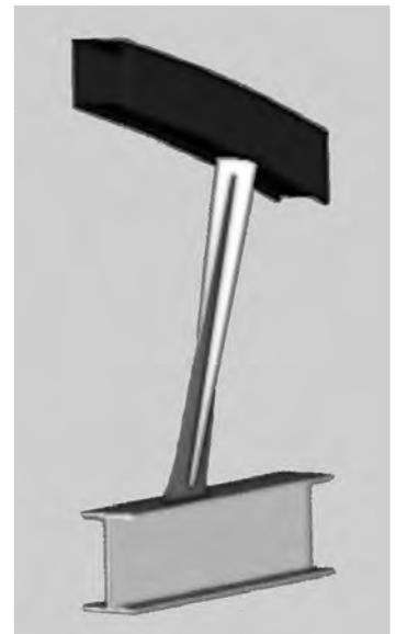
Figure 11 : Schéma d'une suspente
