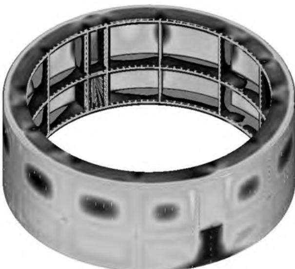
**Figure 8 : Contrainte normale circonférentielle (phase provisoire)**
