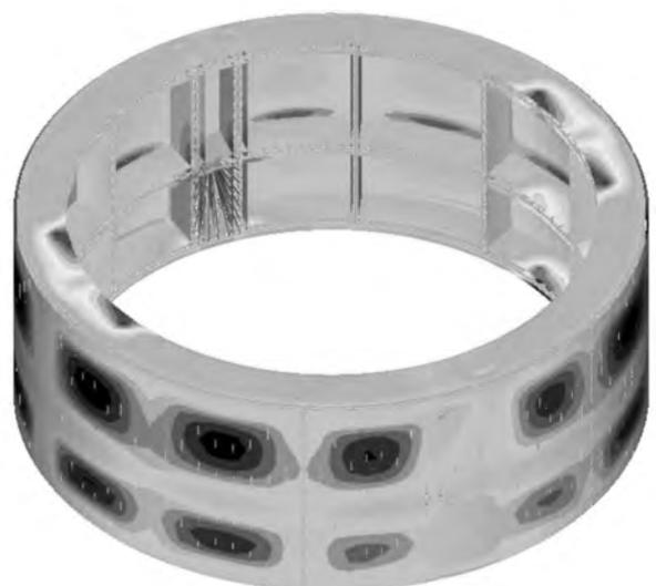
**Figure 9 : Contrainte normale longitudinale (phase provisoire)**
