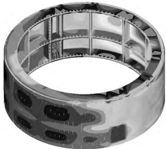
Figure 11 : Contrainte normale longitudinale (combinaison ELU -configuration 2)
