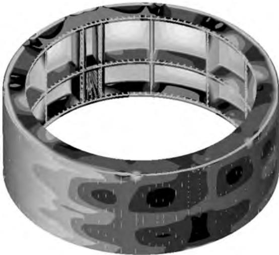
Figure 10 : Contrainte normale longitudinale (combinaison ELS -configuration 1)
