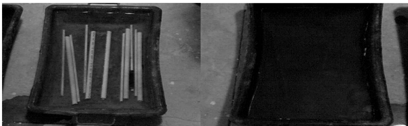
Figure 2 : Immersion des barres dans l'eau de mer
