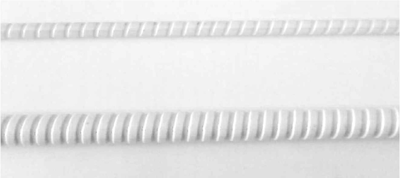
Figure 2 : Barres en PRFV de diamètre 8 et 12 mm.
