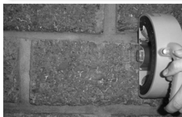
Figure 3. Test au scléromètre - marteau de Schmidt
