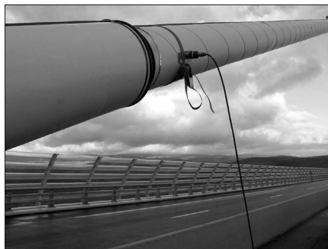
Figure 2 : Viaduc de Millau - position de l'accéléromètre de mesure sur un des haubans
