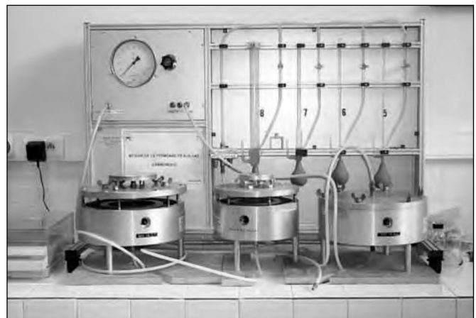
Figure 3 : Appareillage pour la mesure de la perméabilité au gaz
