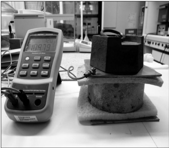
Figure 5 : Dispositif de mesure de la résistivité
