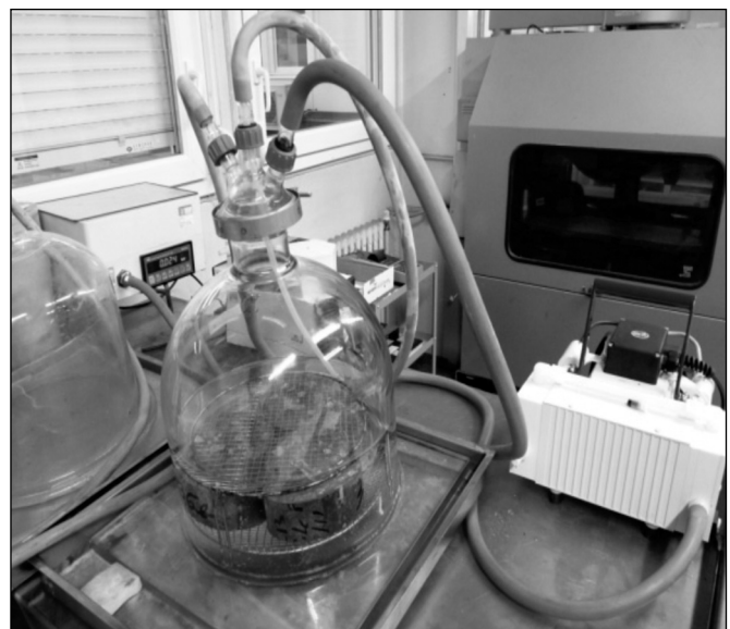
Figure 2 : Cloche à vide pour la mesure de la porosité à l'eau
