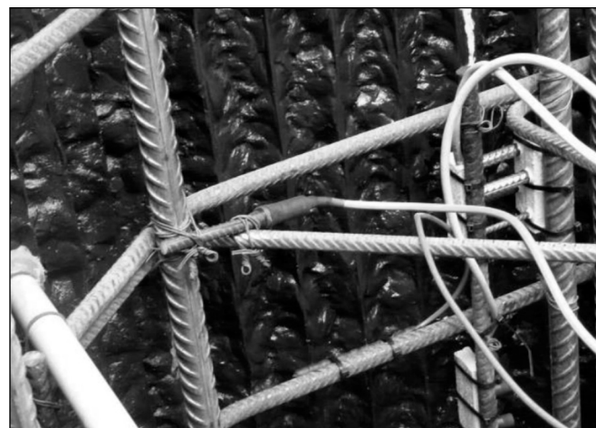
Figure 9 : Vue du capteur de corrosion du LNEC et de la sonde de température Pt100
