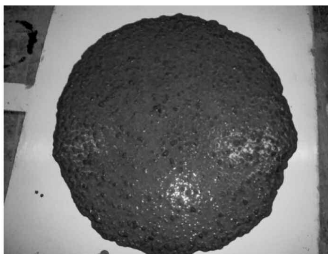
Photo 2. Absence de ressuage et de ségrégation du BAPFC (avec addition de 45 % de FC)
