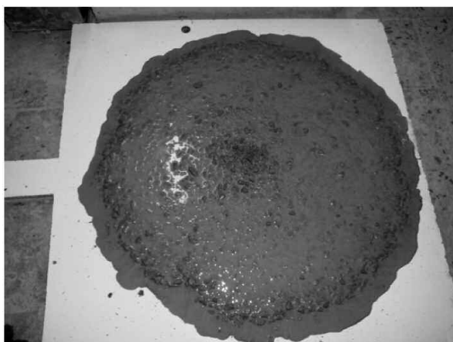
Photo 1. Ressuage et amoncellement des gros granulats au centre du BAP (sans addition)
