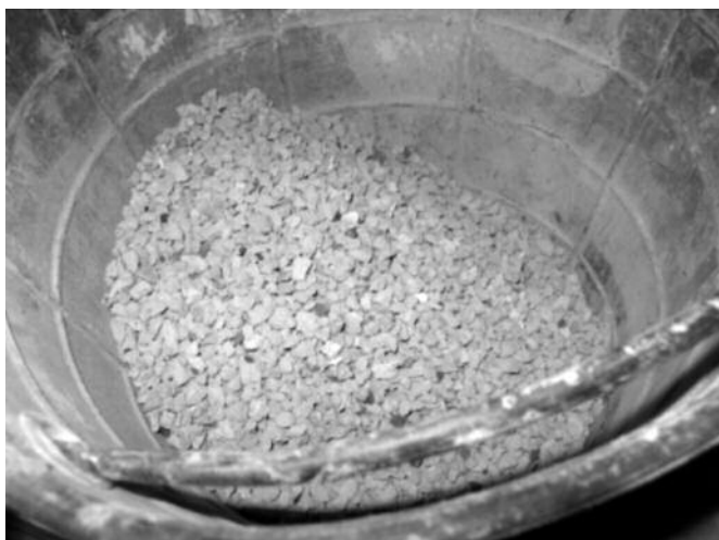
Figure 1. Granulats recyclés incendiés
