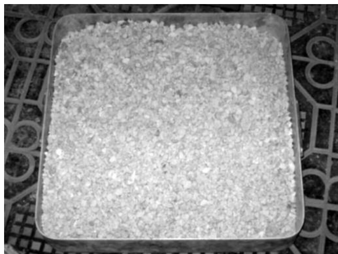
Figure 2. Granulats recyclés non affectés par l'incendie (« sains »)
